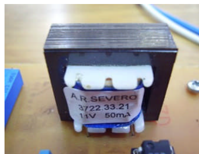
Figura 1. Transformador de Medição
